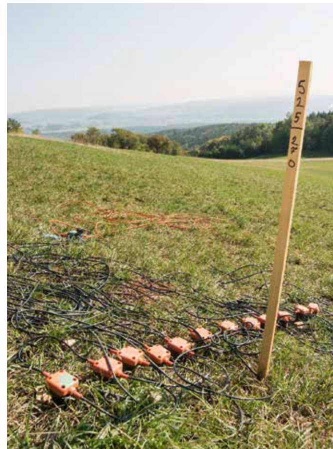
Eine Geofonkette besteht aus jeweils 12 Geofonen. Die Geofone fangen die reflektierten Wellen aus dem Untergrund auf. Quelle: Ernst Müller
