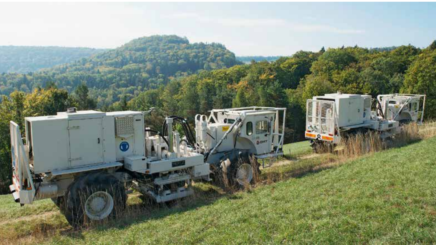
Start der Messkampagne war in Mandach / Villigen. Die Vibrationsfahrzeuge fahren von Anregungspunkt zu Anregungspunkt. Dabei wird alle 30 Meter vibriert. Quelle: Ernst Müller
