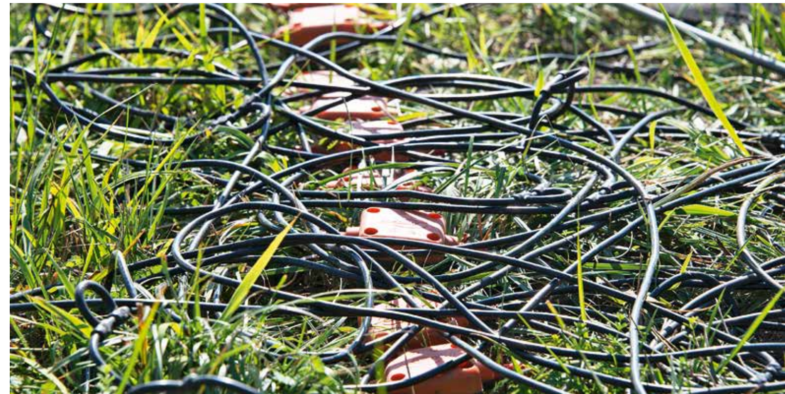
Geofone sind ein wichtiges Werkzeug bei den seismischen Messungen. Sie können vom Funktionsprinzip her mit einem Mikrofon verglichen werden. Sie zeichnen die Wellen auf, die durch das Gestein geschickt werden, und senden das Signal an den Messwagen weiter. Quelle: Ernst Müller
